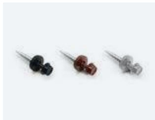
Schrauben Größe: 4,8 x 35 mm Bedarf pro m 2 : ca. 6 – 10 Stück
